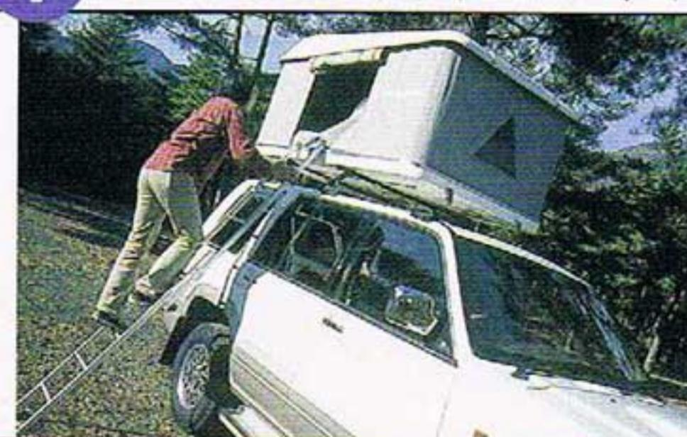
●付属のアルミラダーを使って乗り降りする。防錆加工されたラダーは、クルマの高さに合わせて長さ調節ができる。裸足で乗り降りすると足の裏が痛かったので靴を履いたままだが、その場合、靴の置き場はどうしよう?
